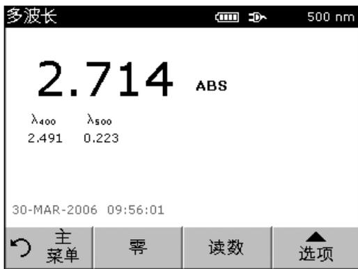
1. 将空白试管插入到试管固定器。按**零**。
