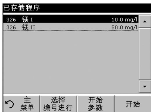
一些测试可用于不同的测量范围。插入样品试管后, 将会显示不同测量范围的列表。
