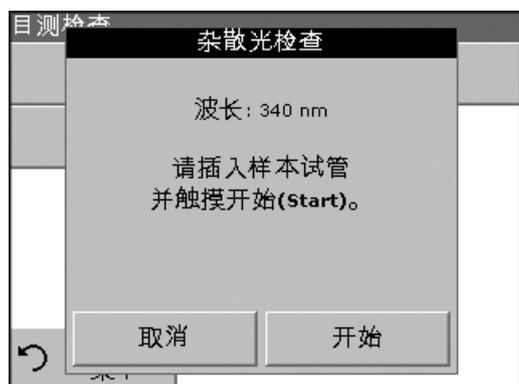
4. 将样本试管插入到试管室#2。关闭试管室。按**开始**。
