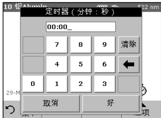
可以在许多程序中使用通用定时器。如果看得到计时器图标，则按该图标并选择**普通计时器**。将显示新屏幕。输入定时间隔长度，然后按**好**以启动计时器。定时间隔结束时，定时器将发出蜂鸣。
