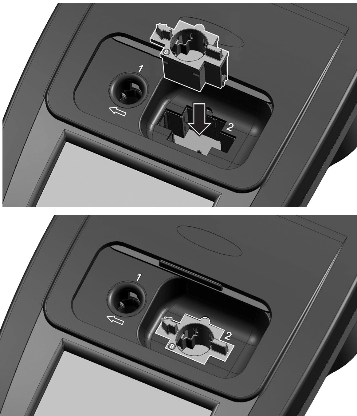
图 5 安装试管适配器
