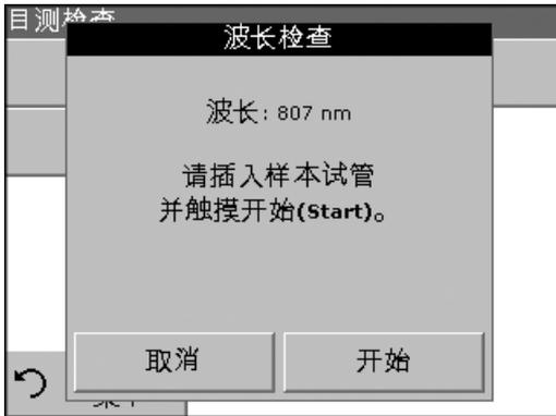
“波长检查”测试用来检查807 nm的波长准确性。波长检查需要过滤器套件 (产品目录号LZV537)。
