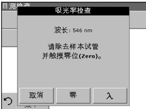
“吸光率检查”测试用来测试仪器中的光度计准确性和重复性。
