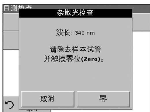
“杂散光测试”用来测量仪器在340 nm的杂散光。
