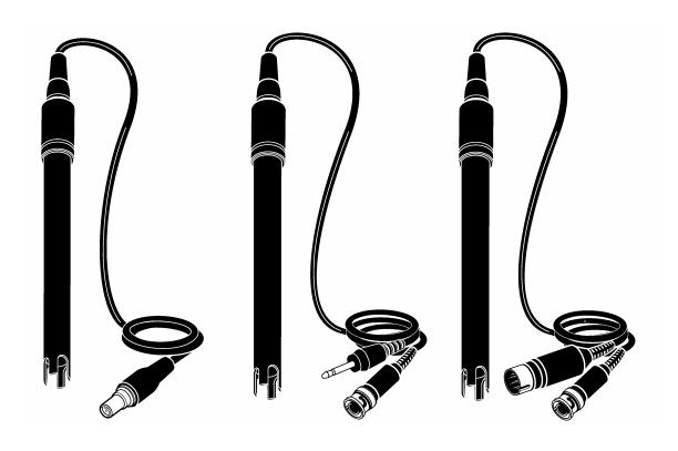
sension 凝胶填充 pH 电极使用烧结玻璃结点的银/氯化银参考电极和一个全程 pH 玻璃测量电极,全程 pH 玻璃电极具备多种应用,特别是极端 pH 值水平下的测定。如果使用 sension系统,仪器会在校准过程中自动考虑缓冲液的温度并将对 pH 值进行补偿。在 sension 仪器内部建立的自动缓冲液识别/自动温度补偿程序含有精密的 pH 图 用于 0 到 60 时 pH 为 4.01、6.86、7.00 和 10.01 的缓冲液。
