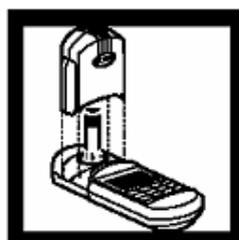
10、擦干净空白消解管的外表面，然后插入 DR890 试管固定架，并盖上遮光盖。
