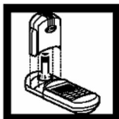
12、擦干净样品消解管的外表面，然后插入 DR890 试管固定架，并盖上遮光盖。
