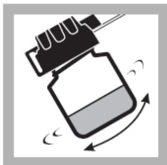
4、立刻盖好反应容器的盖子。旋转进行混合。不要摇晃或反转。不要让水样与试纸垫接触。让反应进行 20 分钟。反应期间旋转 2 次。
