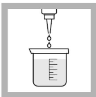
2、如果存在的氯的浓度高于 0.4mg/L，向烧杯中加入 2 滴预先准备好的调节试剂对水样进行中和。
