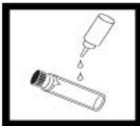
2. 在样品池的顶部滴加一小滴硅油，并使其流向底部—使样品池壁覆盖一层薄薄的硅油即可。
