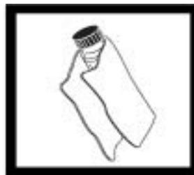
3. 用不起毛的软布均匀。然后擦去多余的油，仅使样品池壁附着一层薄薄的硅油。样品池壁应几乎近干，基本没有或看不见油。
