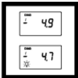
屏幕上将显示 **DIAG** 图标，图标下将显示闪烁的 **1**。仪器将在灯关闭状态下检查电池电压并以伏 (V) 显示结果。然后将显示灯泡图标，仪器会在灯打开的状态下检查电池电压。在默认成灯关闭时的读数前，屏幕上将短暂地显示该数值。如果重复测试，请按 **READ** 键。
