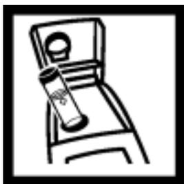
4. 将 0-10NTU Gelex 标准液放入样品池盒中，并使小瓶上的菱形标记对准仪器上的标记。盖上样品池盖。
