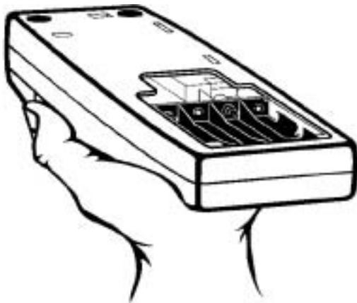
2. 抓住灯装置左边的突出部分， 取下灯装置。 轻轻而平稳地将装置向仪器的后部滑动。
