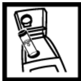
9. 完全混合 90-110NTU 范围的标准液，然后将样品加入样品池至刻度。将样品池放入仪器的样品池盒中。
