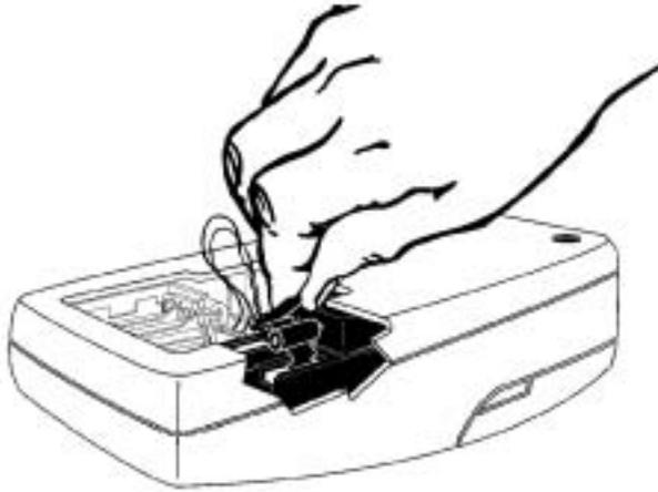
4. 将终端板螺丝拧出一部分（1-2 圈），取出旧的灯头。
